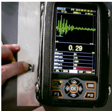
CTS-49 con sonda de 10 MHz
