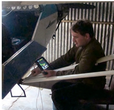
CTS-59 mide los puntales de las alas de un avión pequeño Piper PA-11
