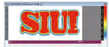
C Scan en amplitud, muestra la amplitud del eco
