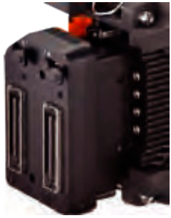
Divisor en Y para dos sondas de matríz en fase
