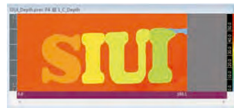
C Scan In-Depth, que muestra la profundidad del eco, se puede utilizar para una inspección sencilla de la corrosión.
