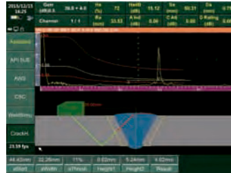
Medición de la altura de la grieta
