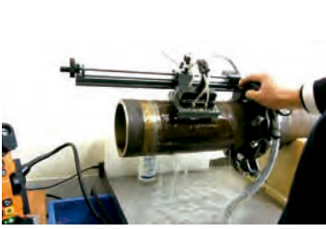
Rastreador de matriz en fase de cadena (eje XY)
