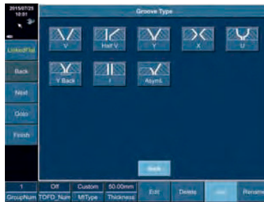
Selección de nuevo tipo de soldadura
